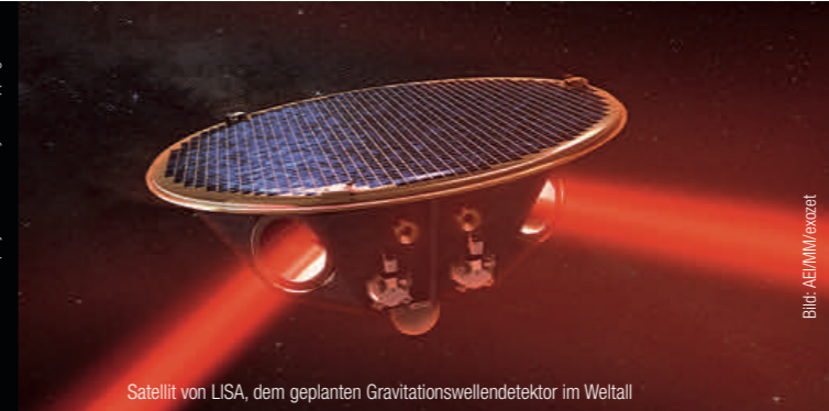
Satellit von LISA, dem geplanten Gravitationswellendetektor im Weltall
